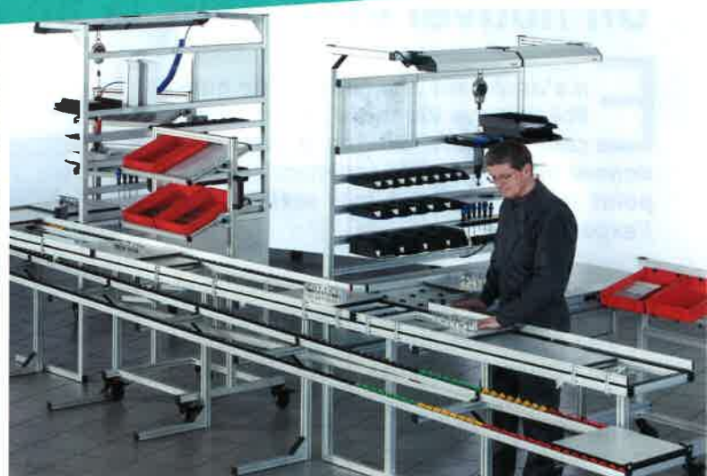
Cellule de fabrication Mersen réalisée par Ergom, optimisée selon la philosophie Lean (cellule en réduction des charges, des déplacements).
