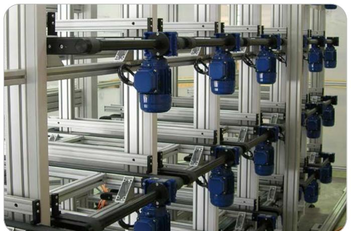
Convoyeur à double bande dans un magasin à rayonnage
