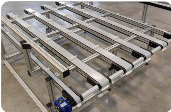
Convoyeur double multi-lignes avec entraînement par courroie crantée
