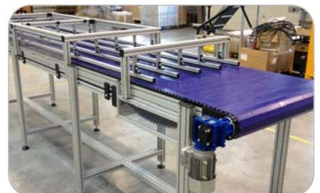
Convoyeur spécial à double bande avec entraînement central
