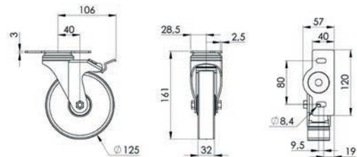
Roulette pivotante D125 à blocage 120x40
