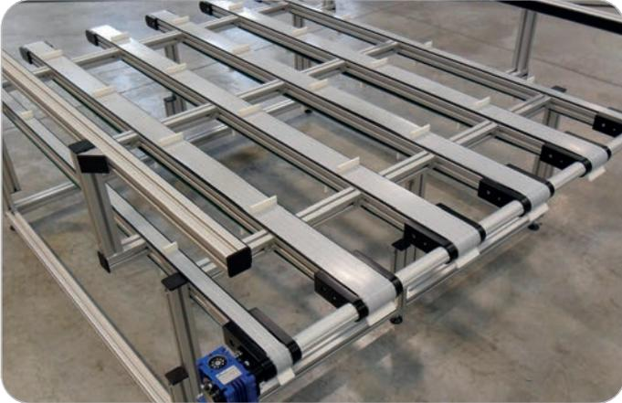
Convoyeur double multi-lignes avec entraînement par courroie crantée
