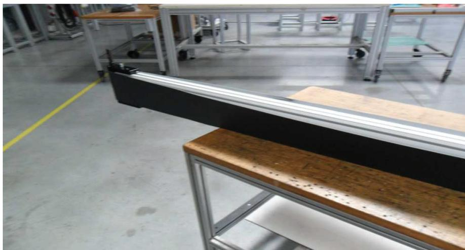
5 - Positionner le convoyeur sur le flan
