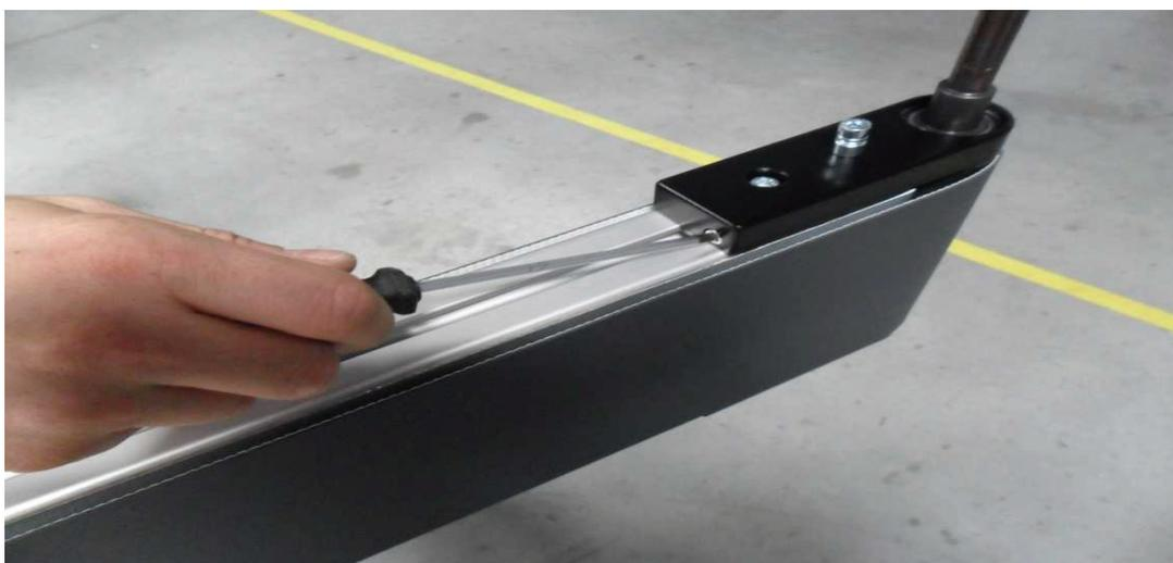
9 - Mettre la bande en contrainte sans tension avec une BTR 4 sur les deux plaques d'entraînement
