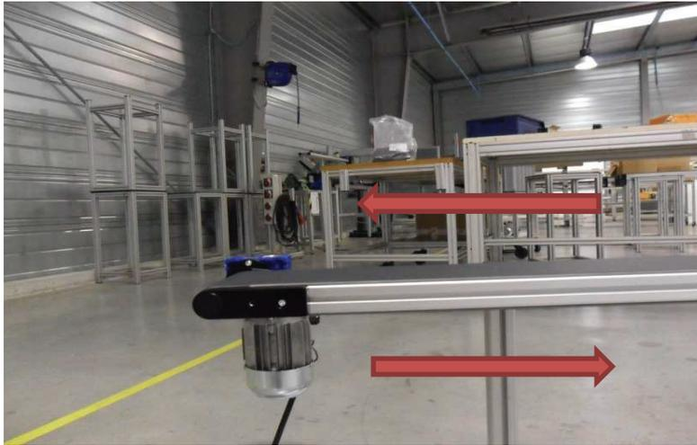
15 - Sens d'avancement standard de la bande et réglage
