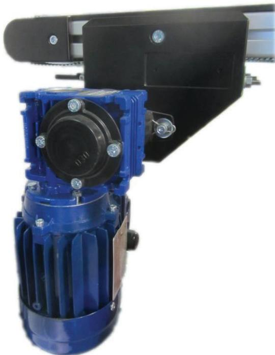
Le moteur est placé à côté de la bande, à l'endroit désiré sur le convoyeur.
