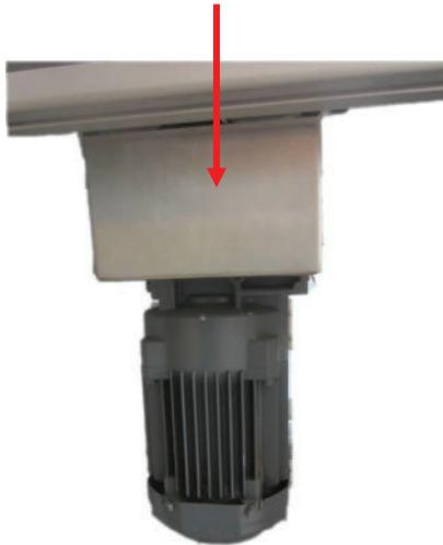
Enlever le carter du moteur en enlevant les deux vis TBHC 5X8 avec une clé à six pans (taille 3).
