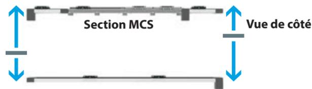
Le parcours MCS en liaison avec le système de transfert est complété par des remontées mécaniques. Cela permet aux supports d'être ramenés sous le processus dans le bâti de la machine. Cela permet une disposition compacte du système avec un accès libre de tous les côtés - idéal pour les machines autonomes ou les modules de production et les concepts de cellule standardisés.
