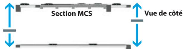
Le parcours MCS en liaison avec le système de transfert est complété par des remontées mécaniques. Cela permet aux palettes d'être ramenées sous le processus dans le bâti de la machine. Cela permet une disposition compacte du système avec un accès libre de tous les côtés - idéal pour les machines autonomes ou les modules de production et les concepts de cellule standardisés.
