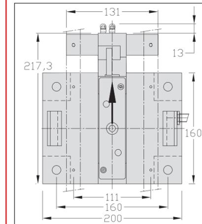
Indexage sur table TLM 1500 avec butée à simple ou double effet
