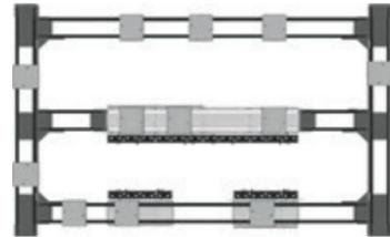
La ligne MCS est intégrée dans une ligne de transfert continue - avec une transition sans heurt de la palette. Les lignes MCS courtes sont parfaites pour rendre les stations de traitement individuelles plus flexibles et optimiser les temps de cycle. Le trajet de transport entre les stations est réalisé avec le système de transfert.
