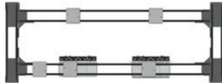
La section MCS est installée entre deux sections du système de transfert. Les sections MCS plus longues sont idéales si plusieurs stations de processus doivent être mises en œuvre à la suite de manière plus flexible et dynamique. Vous pouvez connecter facilement et de manière transparente le système de transfert pour la circulation.
