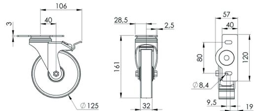
Roulette pivotante D125 à blocage 120x40
