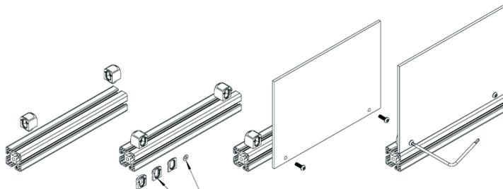
Rondelle imperdable ou cales d'épaisseur 2, 3 et 5mm (accumulable) en option
