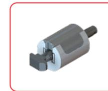
Le connecteur perpendiculaire permet de fixer 1 profilé tube D28-M8 perpendiculairement sur un profilé rainure de 10, sans usinage.
